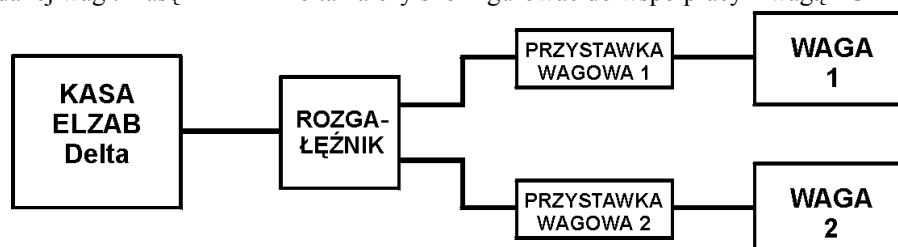
Rys. 2-3 Schemat blokowy połączenia kasy Delta i 2 wag przez Przystawki Wagowe
