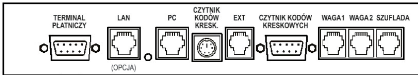
Rys. 1-2 Widok na złącza interfejsów (od spodu kasy)
